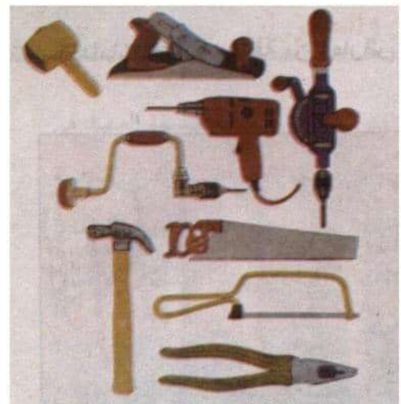
عدد نجارة تستخدم فى الحفر وزخرفة الأخشاب مكونة من : مثقاب - شينور - ملف - فارة - منشار - منشار اركت - ذراعية - چاكوش - دقماق .
